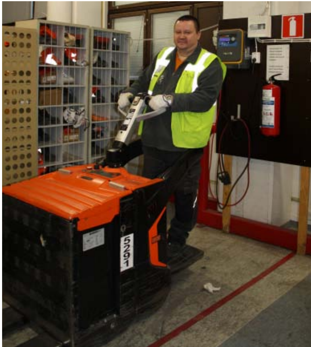
Lavansiirtovaunut toimivat sähköllä ja ne haetaan latauksen jälkeen ajoon latauspisteeltä.
