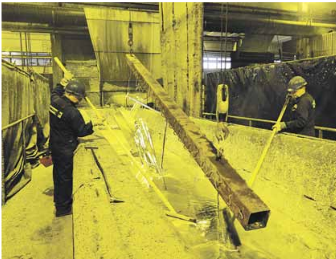
Sinkittävä kappale puhdistetaan ensin peittaamalla se miedossa suolahappoliuoksessa. Sen jälkeen kappale upotetaan 530 asteiseen sulaan sinkkiin. Kuvassa käsittelyssä on laivaputkinippu.
