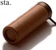
Piikkihallipatruuna, käytössä n. vuodesta 1835. Patruunanvalmistus lopetettiin 1930-luvulla.
