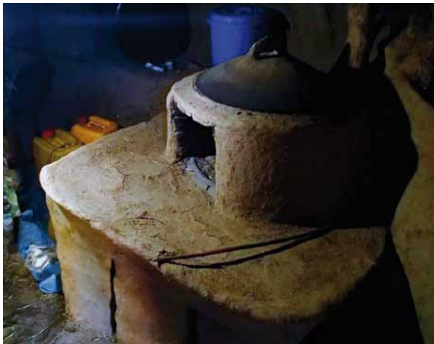
Puita säästävällä liedellä polttopuun kulutus on vain vajaa puolet entisestä.
