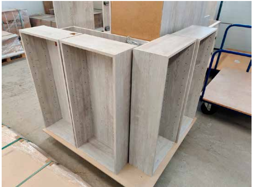
Kalusterunkoja lähdössä asiakkaalle ilman lastulevyä. Nämä kalusterungot ovat valmistettu melamiinipintaisesta MDF-levystä.
