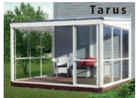
Tarus-valmisterassi on kiinnostanut monia. Kooltaan 12 m 2 :n terassin runko on liimapuuta, seinät liukulasia ja katto PC-kerroslevyä.
