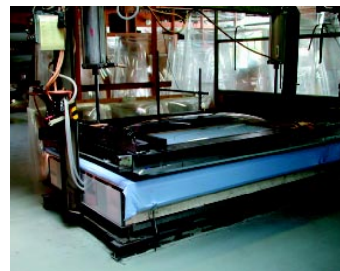
Tasaisesti lämmitetty akryylilevy taipuu muotoonsa ilman muottia ilmanpaineen avulla.
