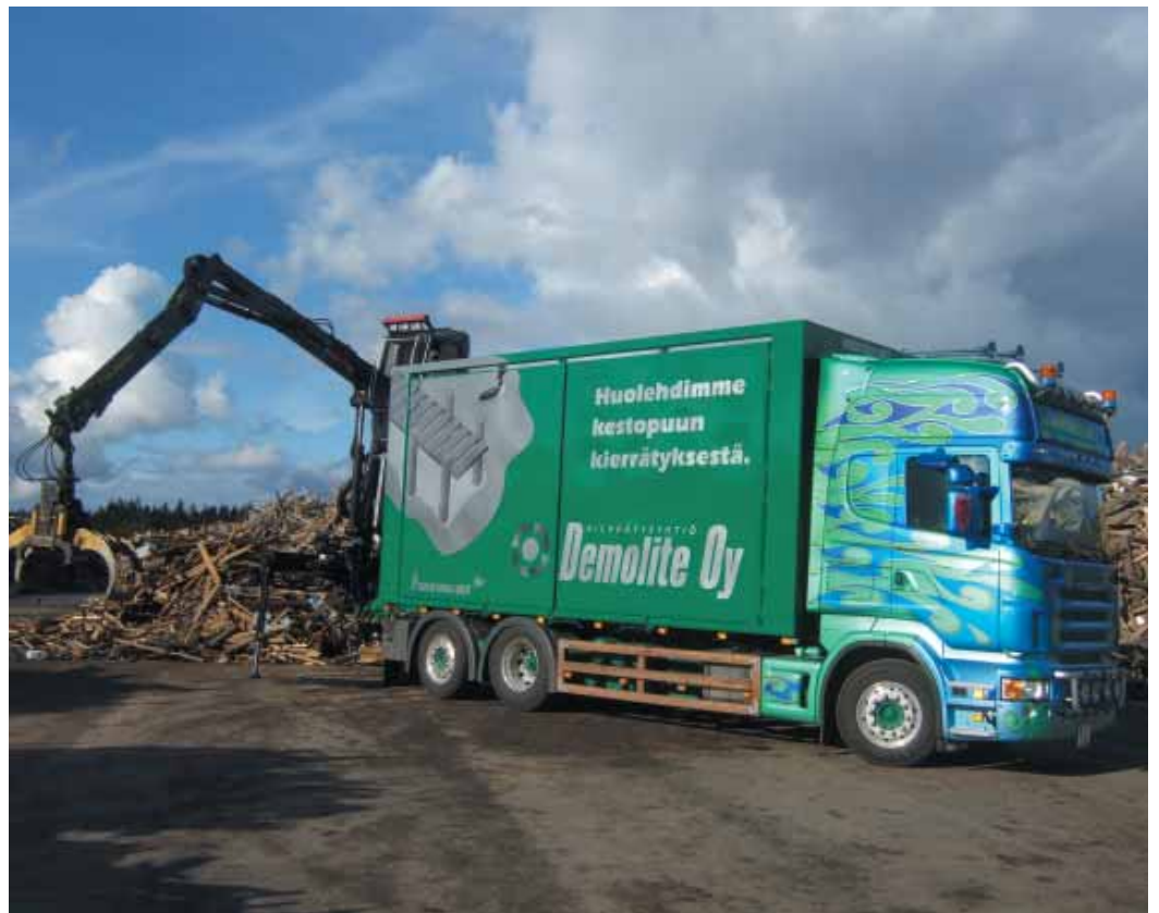
Autoyhtymä Hakkaraisen & Pojat ajaa Demoliten kirkaissa väreissä. Kuormain kulkee nupin mukana perälaudassa.
