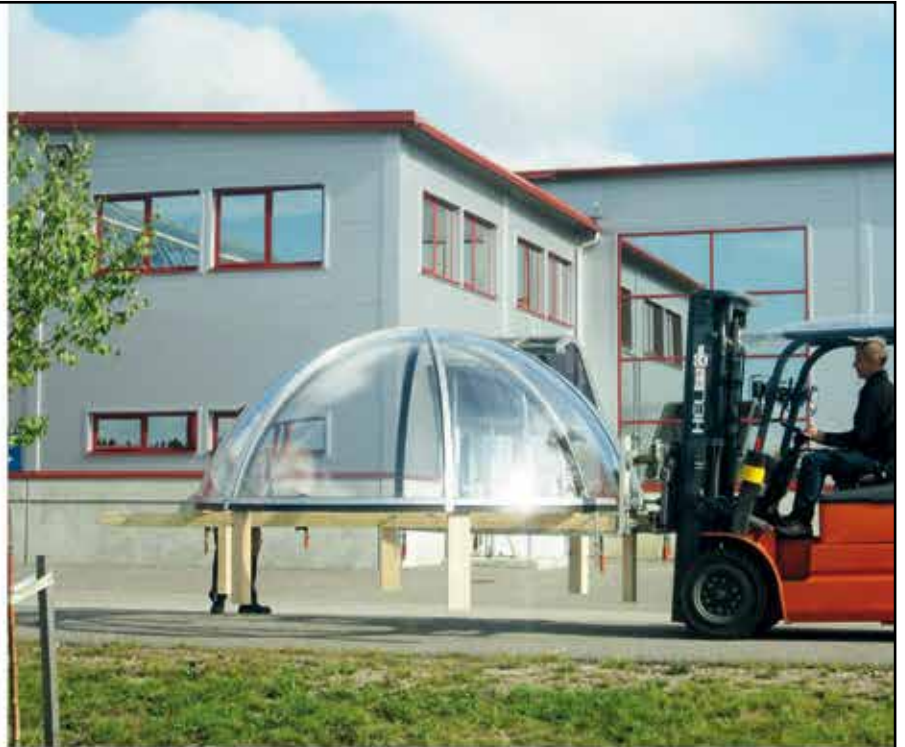
Erähotelli Nellimille toimitettavaa suurkanavia [Ø 3,3 m] viedään pakattavaksi. Kuvut asennetaan elämysvierasmajojen katoiksi.
