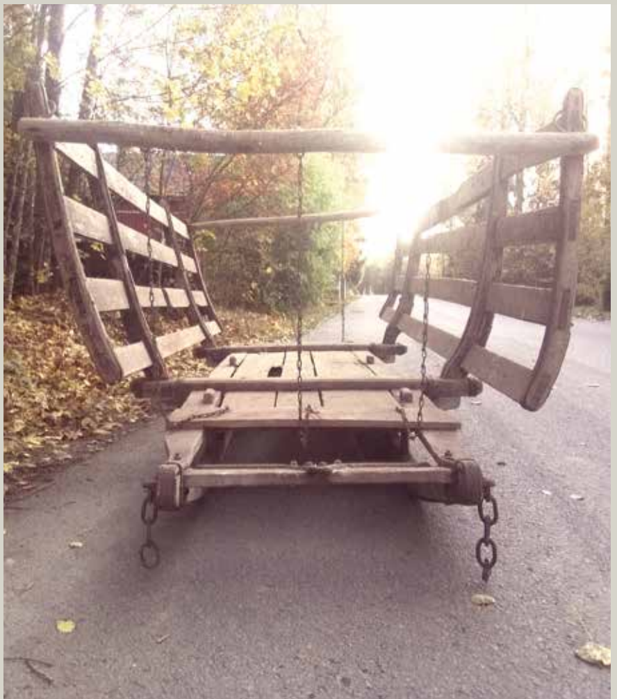
Heinähäkkireki jolla ajettiin kesällä heiniä latoon siten, että hevospari veti rekeä parikakkuilla. Talvella ajettaessa häkkirekeä veti yksi hevonen talvikakkuilla. Kuva: Mikko Yli-Rosti.
