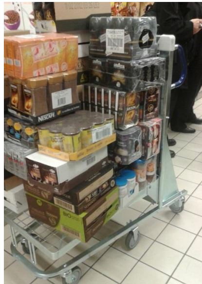
Apuvälineestä on hyötyä asiakkaille, ja se soveltuu alle 15 kiloa painavien tuotteiden hyllytykseen. Apuväline vähentää hartioihin kohdistuvaa rasitusta tarjoamalla pakkaukselle staattista tukea.
