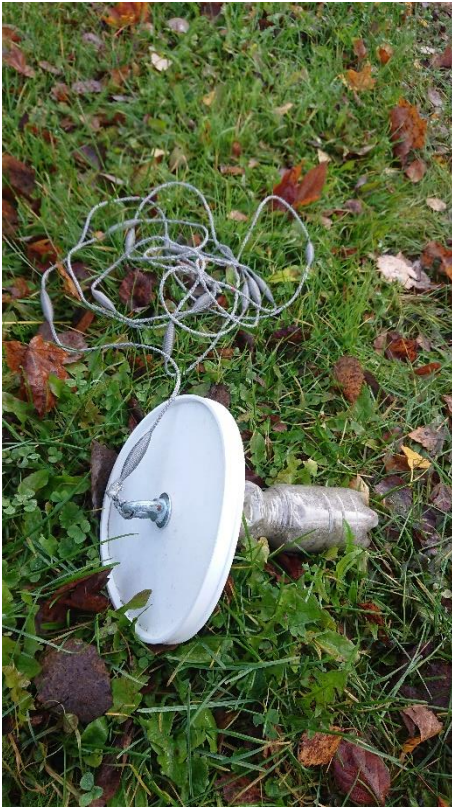
Kuva 5. Näkösyvyyden mittalevy on helppo rakentaa itse kotoa löytyvistä materiaaleista.
