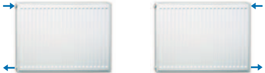
Päätykytkentä samassa päädissä
