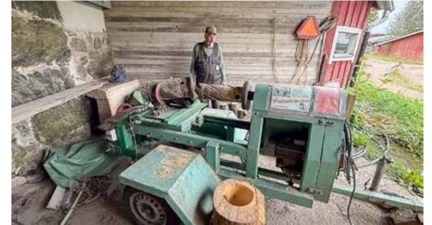
Uutut on valmistettu ainutlaatuisella uuttusorvilla, joka on saanut nimekseen Palokärki. Kuvassa uuttujen valmistaja ja legendaarinen lintujen rengastaja Kari Hiivola. Kuva: Reima Orvasto.
