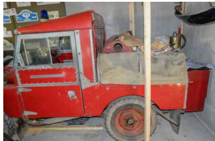
Auton perässä, punaisessa laatikossa, on kiinteästi asennettu palopumppu. Kuva: Erkki Rantala.
