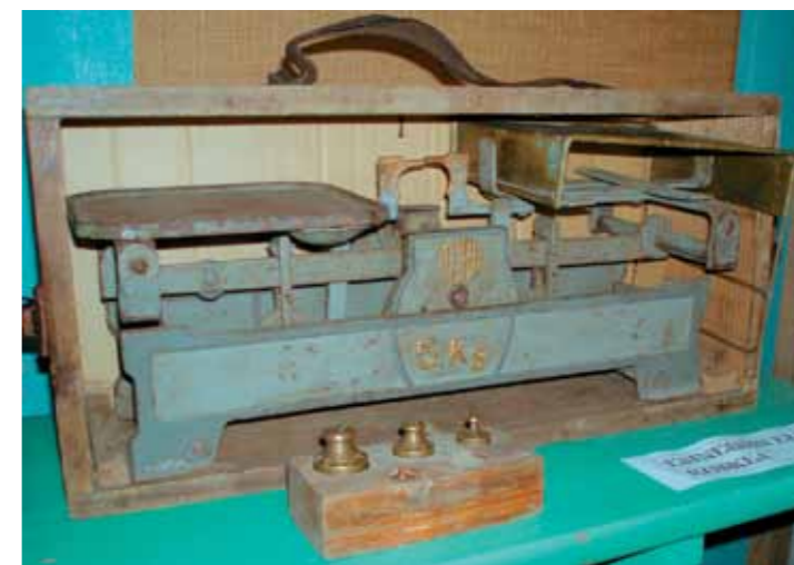
Vanha torikauppiaan ”matkavaaka” oli aikansa suunnittelun ja rationalisoinnin huppu. Siinä kulki vartavasten vaakaa varten rakennetussa kopassa koko punnitusvälineistö.
