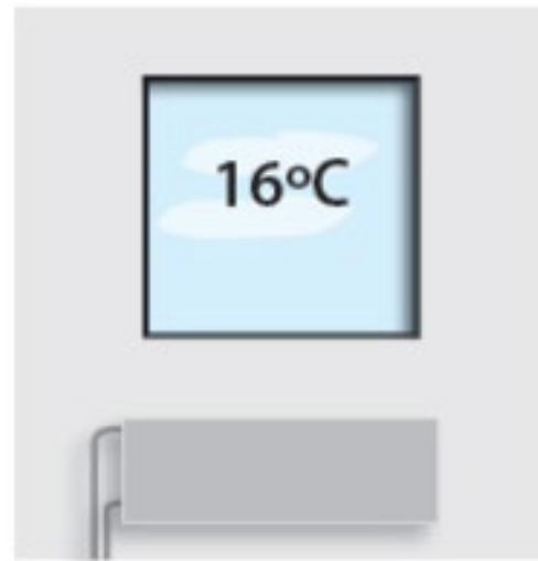
3-lasinen ikkuna eristyslaselementillä U-arvo 0,7 W/m 2 K
