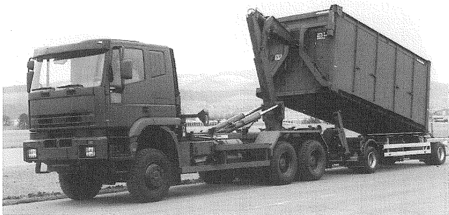
Hiab-kappalenosturi ja multilift-koukkulaite tekevät ajoneuvosta monipuolisen kuljetusvälineen.
