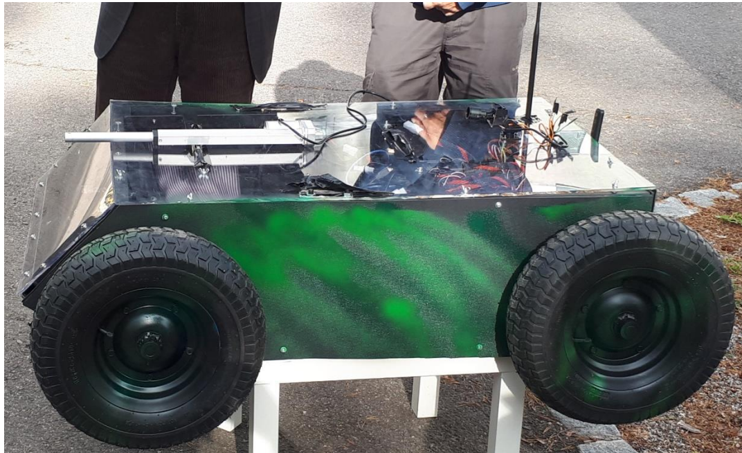
Autonomisen panssarintorjuntarobotin demonstraattori (Ylii, DI C. Andersson)
