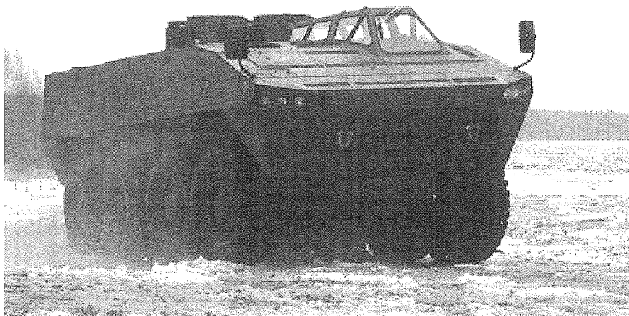
Kuva 1. Patria AMV 8x8 prototyyppi talvella 2001, huomaa lisäpainot ja ajan testikuomu.
