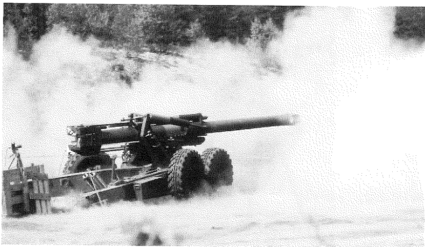
Kuvassa kenttätykki 155K 83 vaihtoehtoisesti 39, 45, 52 pituuskaliiperin tuliputkella varustettuna. Kantama 40 km. Normaali tulinopeus 8 ls/min. Paino 10,5 t.
