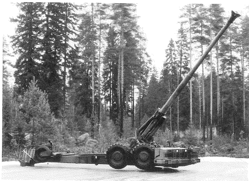
Apumootorilla varustettu hydraulisesti liikuteltava 155 GH 52 APU -tykki. Kantama 40 km. Maksimijonopeus omalla voimalaitteella ajettaessa 15 km/h, hinauksessa 80 km/h. Tykin paino 13,5 t.
