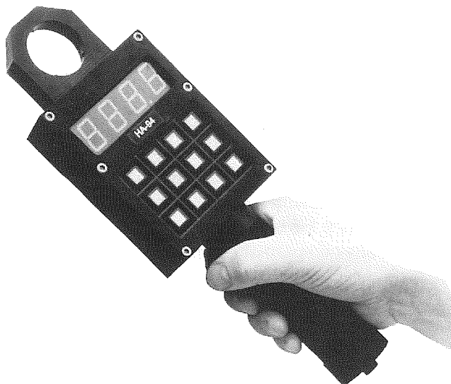
Herätesytyttimen HS-94 (hes S94-36A) ohjelmointilaite.
