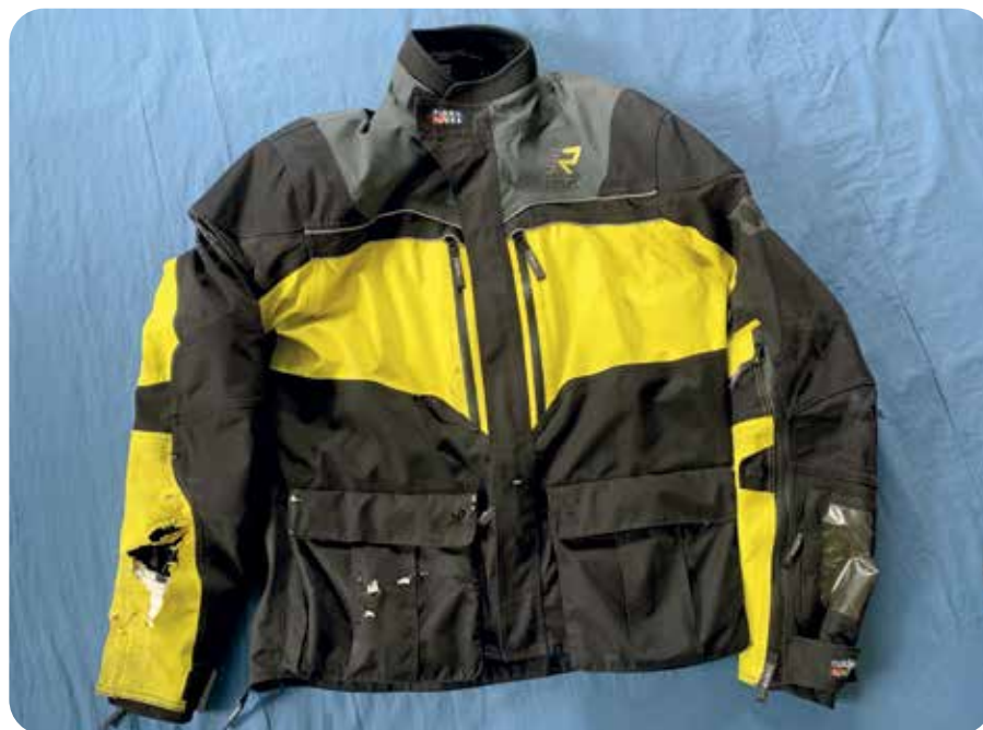
10 Takissa pahimmat vauriot tulivat oikeaan hihaan, jossa repeämä on melkoisen suuri. Hihaan sijaitettu suoja esti kuitenkin käden hankaantumisen asfalttiin, vaikka suojoissa oleva jälki oli varsin pieni.
