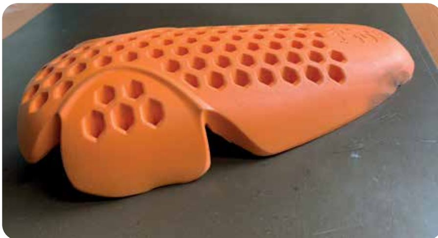
Oikea kyynärsuoja. Suojan kärjessä pieni hankaumajälki. Ainoa suoja, johon tuli jälkiä ylipäättään tapahtuman seurauksena.
