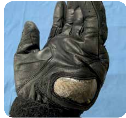
Hanskan peukalonhangan kohdalla ollut kovike suojaasi kämmettä tehokkaasti
