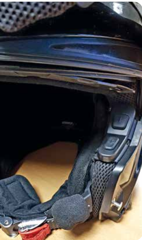
SC10U -laitteiston mikrofoni, ohjainnäppäimet sekä keskusyksikkö asennettuina kypärään
