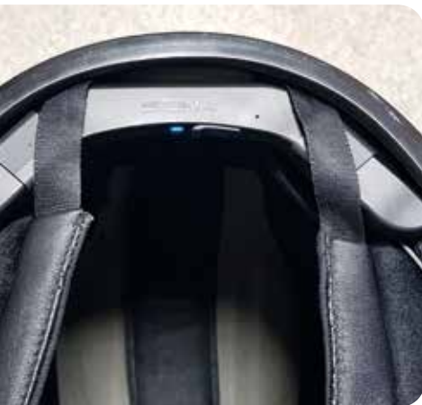
SC10U -laitteiston mikrofoni, ohjainnäppäimet sekä keskusyksikkö asennettuina kypärään
