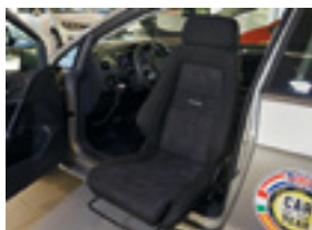
Kuljettajan kääntöistuin tekee autoon siirtymisen helpommaksi.
