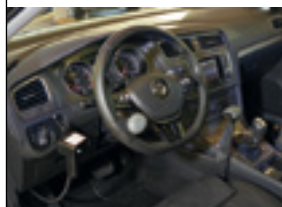
Kaasun ja jarrun käsihallintalaitte ja rattinuppi helpottavat auton käsittelyä.
