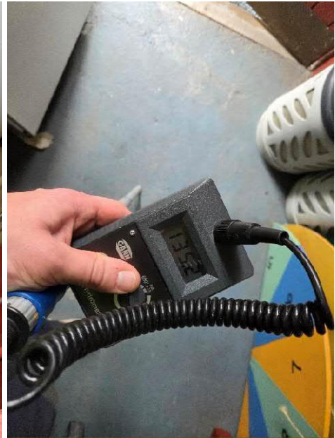
Kuva 10 Kuva 11. Maalatussa betonilattiasa havaittiin paikoin maalipinnan kulumista, pientä halkeilua sekä paikallisia kohonneita pintakosteuden arvoja.
