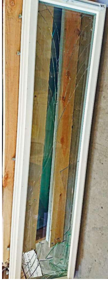
Kuva 3. Marttorojatilla (3.0 kN/m 2 ), tuulenpaineita voisi vielä kasvatata, mutta käyttörajatilan taipumarajana yleisesti pidetty L/100 (L = pienempi mitta) tulee vastaan.
