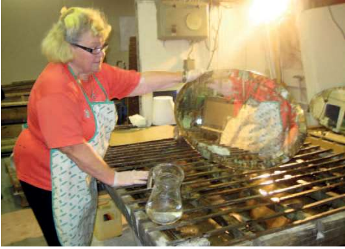
Vuonna 1952 Hämeenlinnaan perustettu Hämeen Lasitoimi Oy tekee nykyisin vaativia rakennuslasituksia, mutta hopeoi myös uudelleen vanhoja peilejä. Kuvassa Anja Selinko hopeoi uudelleen vanhoja peilejä vuonna 2017. Kuva: Kaisa Koivisto / Suomen lasimuseo
