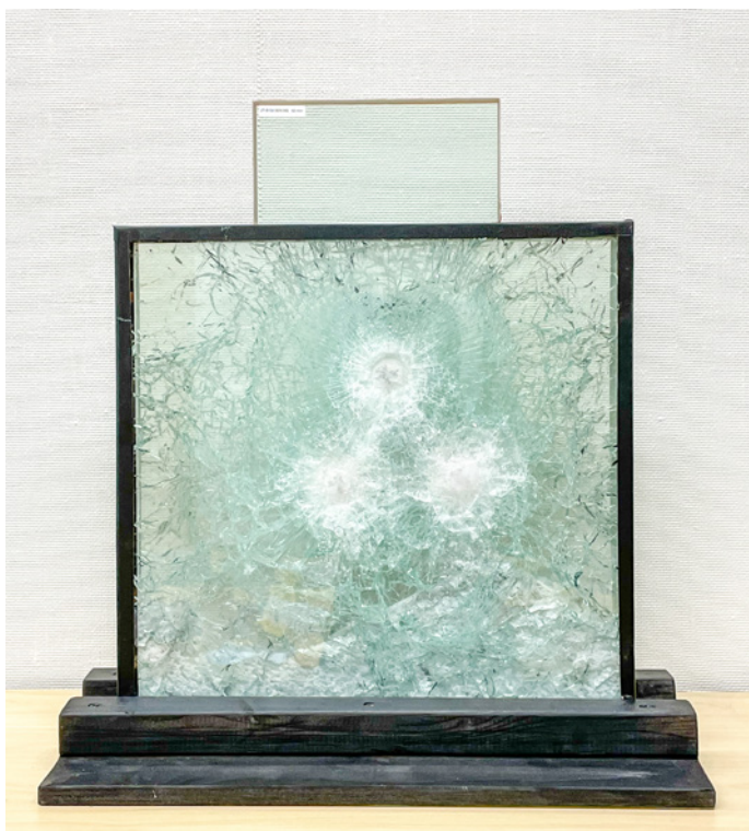
Testiammattu JT-S160 BR6 NS (EN 1063) ja päällä mallipala JT-S150 BR6 NS (EN 1063).
