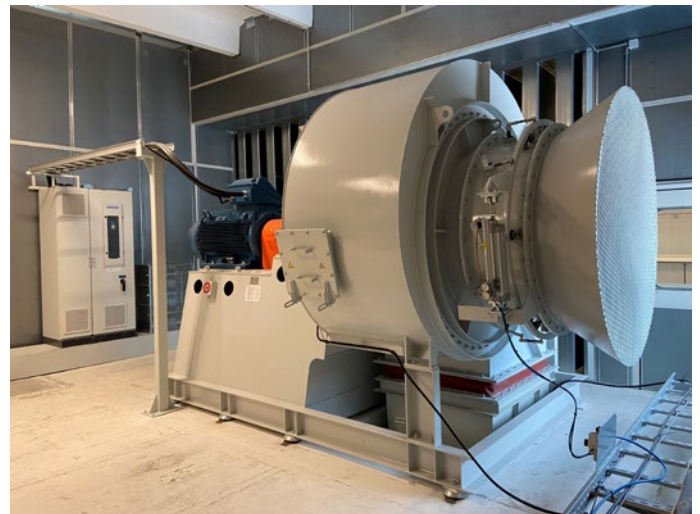
Nykyaikainen karkaisupuhallin, joka on varustettu taajuusmuuttajalla, jarruvastuksella ja siipisäätimellä.
