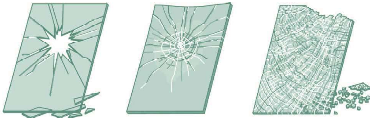
Kuva 4. Tavallisen lasin, laminoituneen lasin ja karkaistun lasin rikkoutumiskuvia. (RT 38-10901).
