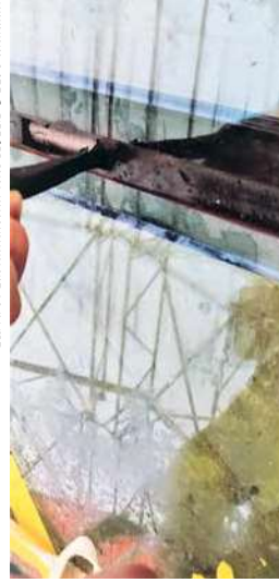
Kuva 5: Tartuntatestiä teko. ASTM C.1193 mukaan
