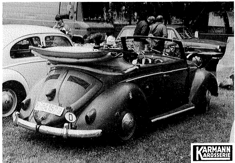
1949 Karmann Cabriolet projekti Bad Cambergissa v. 1991. Väärät takavalot ja puskurit, mutta kiinnostava kohde suht' hyvän kuntosaa ja ikänsä puolesta.
