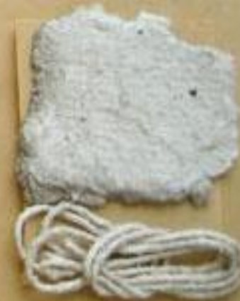
Krysotiili-asbesti- eristettä ja -narua (valkoista asbestia)
