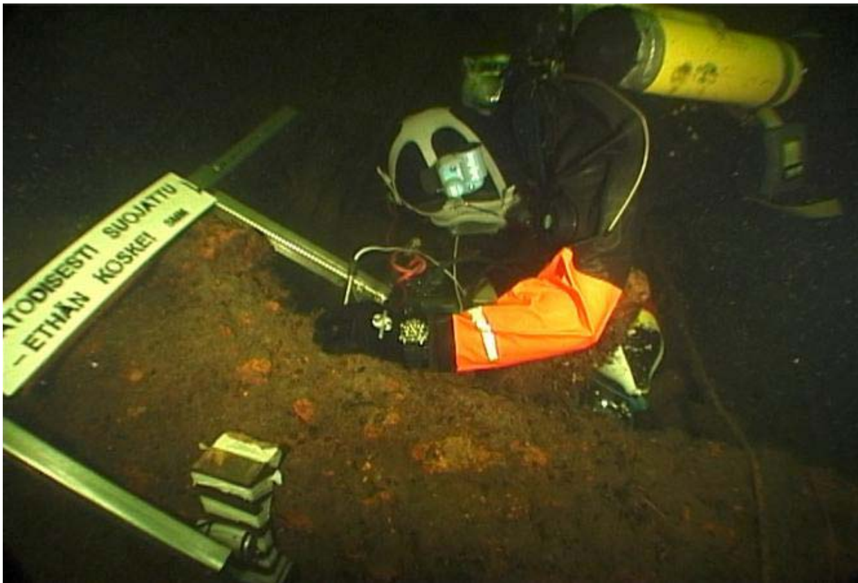
Kuva 1. Katodisesti suojatun tykin AT6 pH-mittausta in situ (P.Paanasalo / Museovirasto).
