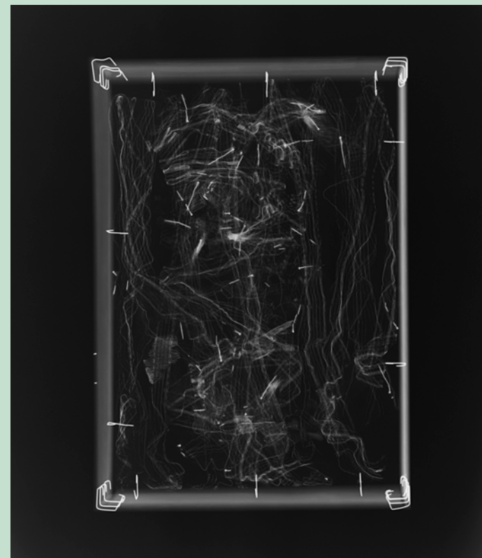
Jotta aineisto voitiin purkaa laatikosta turvallisesti, vanha säilytyslaatikko röntgenkuvattiin.
