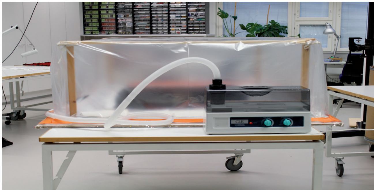
Kuva 4. Messukasukan konservointia varten rakennettu kosteuskammio.
