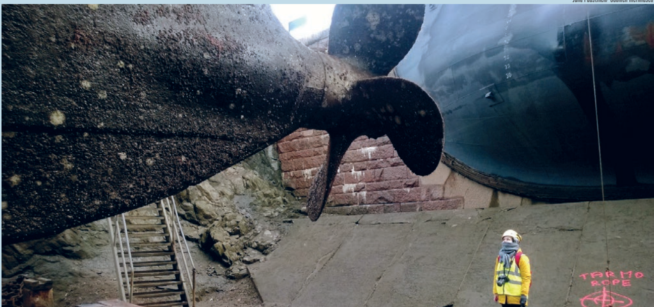
Suomen merimuseon konservattori Taru Laakkonen tarkastelee Tarmon keulapotkuria.
