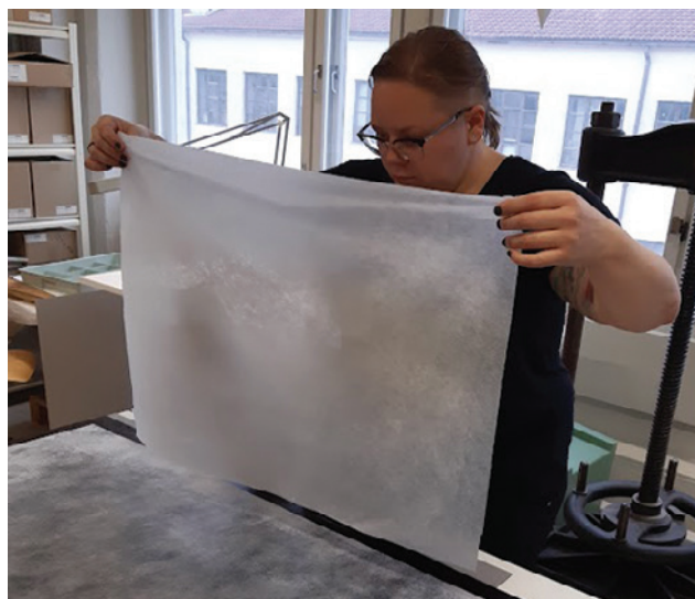
Method R: Hollytexin päälle tuleva kosteutettu japaninpaperi.
