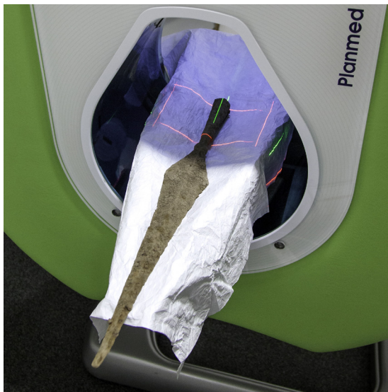
Kiehkänkärki KM 40079:1 kuvauskammion sisällä. Vihreä ja punainen laservalo helpottavat kohteen asemoimista kammion sisällä.
