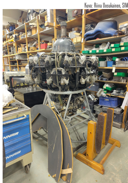
Yhdysvaltalaisen Pratt & Whitneyn valmistama DC3-lentokoneen Twin Wasp SIC3 (R-1830-92) 14-sylinterinen ilmajäähdytteinen kaksirivinen tähti-moottori. Moottori painaa 665 kiloa. Moottori on asetettu VI Myrsky II -hävittäjälentokoneen moottoripukista valmistettuun telineeseen. Myrskyn replikka rakennettiin museolla vuosina 2014-2024.
