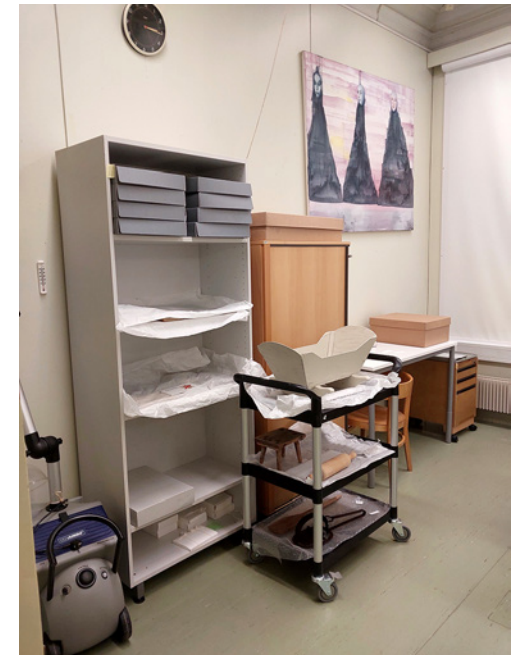
Keskikokoisille esineille on erilaisia nostopöytiä ja pyörällisiä alustoja ja pienemmille kärryjä. Työskentelyn tiloissa (ja koko rakennuksessa) enimmäkseen yksin ja onhan esineturvallisuudenkin takia hyvä välttää kantamista. Liikuteltavaa suodatinyksikköä käytän isojen esineiden kanssa esimerkiksi lakan elvytyksessä.
