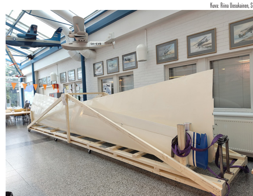
Antti Laukkanen ja Tero Liljamon rakentama purjelentokoneen siirto- ja säilytysteline.
