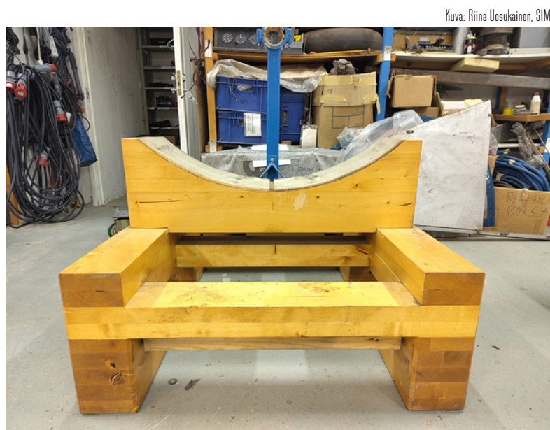
DC3:n kaksiriviselle tähtimoottorille aikoinaan rakennettu oma teline, johon se palautetaan käsittelyprosessin jälkeen.
