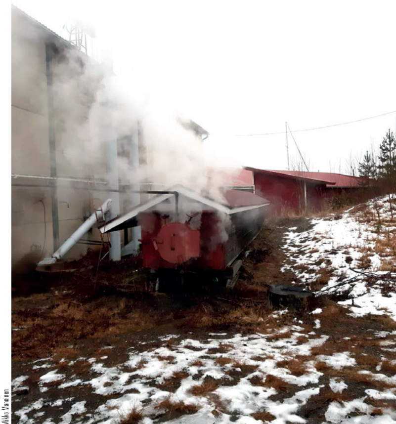
Lankkujen pasutus eli höyrytys käynnissä.
