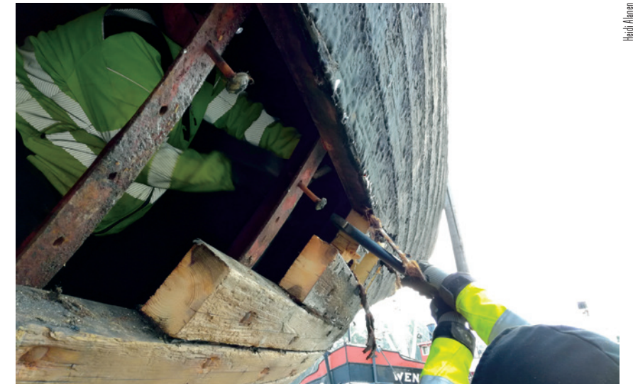
Kylkilankkujen poistoa halkoboksien alueella.
