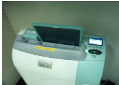
Metropolian Shimadzun liikutettava röntgenvaunu (vas.) ja Fujifilmin FCR Capsula XLII skanneri (kesk.). Oikealla Trondheimin NTNU Vitenskapsmuseetin GE CR Flex skanneri, johon kuvalevyä kasetissaan juuri syötetään. Kuvat: Pia Klaavu.
