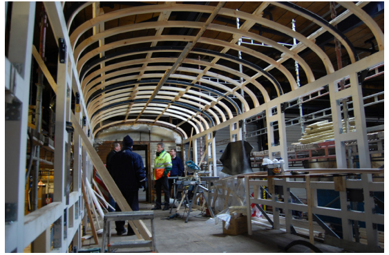
Vaunu Ei 22272 runkotyövaiheessa VR:n Pieksämäen konepajalla keväällä 2011. Kuvasta hahmottuu selkeästi, kuinka perusteellisesti vaunu oli puuosiltaan rakennettava uudelleen.
