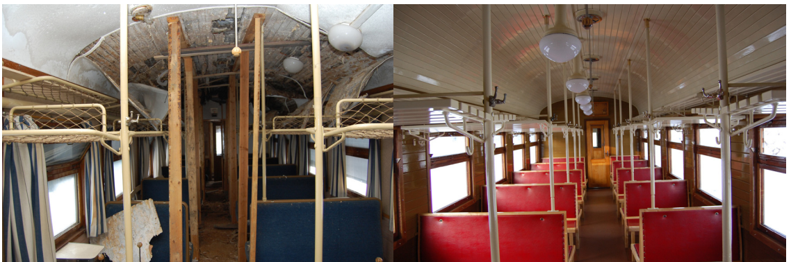
Päivävaunu Ei 22272 oli vaurioitunut erittäin pahoin, ja se oli hyvin pitkälti puuosiltaan uudelleenrakennettava. Tästä syystä vaunu päätettiin palauttaa varhaisimpaan asuunsa. Kuvassa vaunu ennen entisöintiä, sekä entisöinnin jälkeen. Entisöidystä vaunusta puuttuvat vielä kuvassa verhot, sekä muita interiöörien yksityiskohdita.
