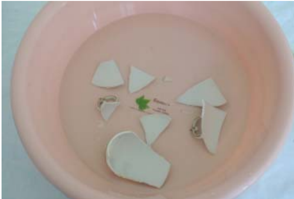
Kuva 4: Liimaukset aukesivat vedessä. (Kuva: Heikki Häyhä)
