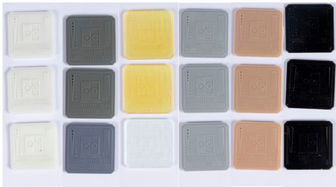
Kuva 1. Kappaleissa tapahtunut värinmuutos. Kaksi ylemmää kappaletta ovat ikäännytettyjä ja alin on verrokki. Materiaalit ovat järjestyksessä: Phrozen: ABS-like, Phrozen: Aqua resin, Liqcreate: Clear impact, Liqcreate: Dental pro, Formfutura: Dental Gypsum ja Phrozen: Water-washable.
