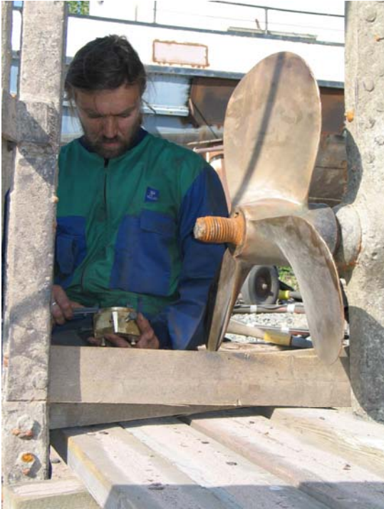
Konemestari mittailemassa mutterin kierteiden lisäkoneistustarvetta
