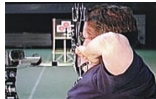
Lasermittauslaite kiinnitettynä vakaajaan ja samanaikainen videokuvaus laukaisusta antaa selkeän kuvan todellisista tapahtumista.
