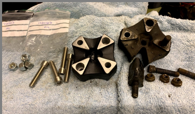
Tilaa samalla uudet kiinnityspultit ja –mutterit
