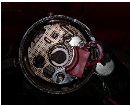
Kuva: Sytytysmoduuli asennettuna jakajaan.
