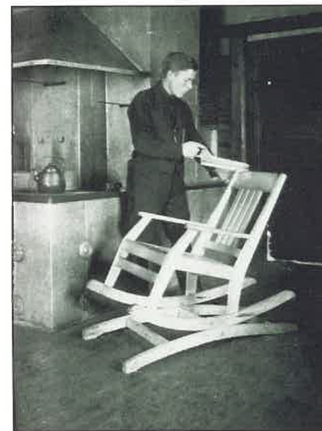
5) Elis Eloranta oli myös puuseppä. Tässä hän viimeistelee n.s. amerikkalaismallista keinutuolia. Jalasten väliin pantiin rautalankainen varppi, tuoli keinui pehmeästi eikä kaatunut.
