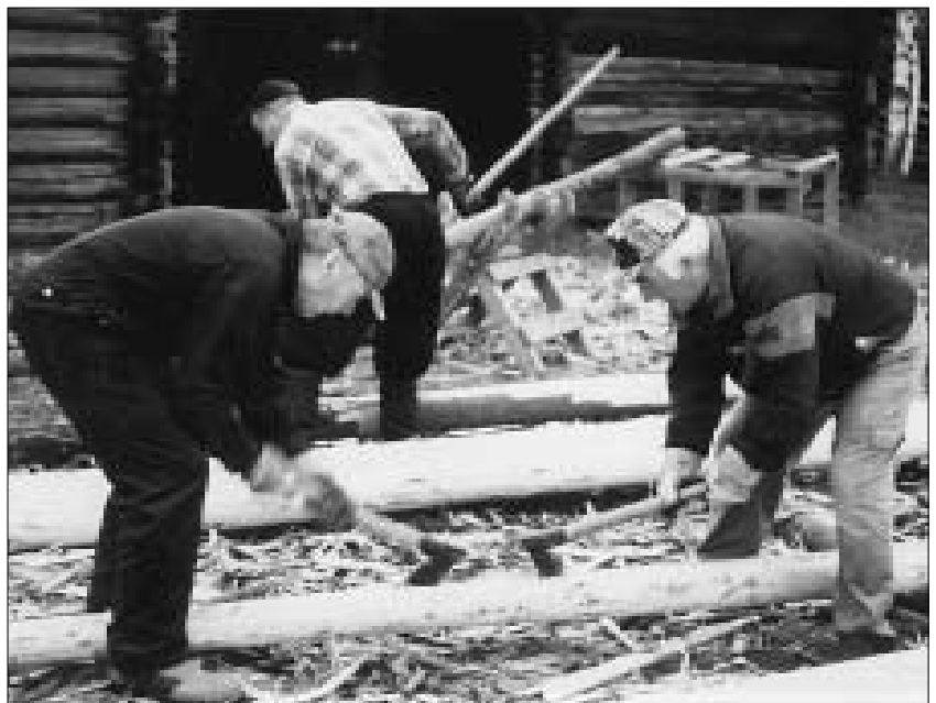
Kuoritut puut halkastaan pulikkaiks. Halkasemas Eero Älli, Voitto Ollonqvist ja takan Juhani Talonen.
